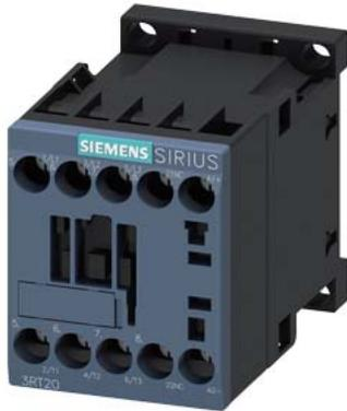
contattore di potenza, AC-3e/AC-3, 9 A, 4 kW / 400 V, a 3 poli, DC 24 V, contatti ausiliari: 1 NC, morsetti a vite, grandezza costruttiva: S00
