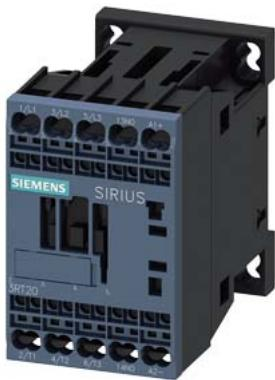
contattore di potenza, AC-3e/AC-3, 7 A, 3 kW / 400 V, a 3 poli, DC 60 V, contatti ausiliari: 1 NO, morsetti a molla, grandezza costruttiva: S00
