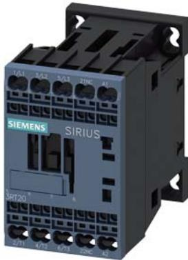
contattore di potenza, AC-3e/AC-3, 7 A, 3 kW / 400 V, a 3 poli, AC 400 V, 50/60 Hz, contatti ausiliari: 1 NC, morsetti a molla, grandezza costruttiva: S00
