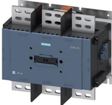
contattore di potenza, AC-1 2100 A, a 3 poli AC (50...60 Hz) / comando in DC AC 100...240 V / DC 100...220 V azionamento: elettronico contatti ausiliari 2 NO + 2 NC attacchi a sbarra blocchetto di contatti ausiliari e terminali della bobina in tecnica di collegamento a vite
