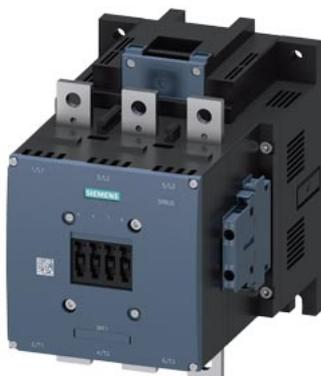
contattore, AC-1, 690 A/690 V/40 °C, S12, a 3 poli, AC/DC 500 ... 550 V, con varistore, 2NO+2NC, sbarra di collegamento/ morsetti a vite
