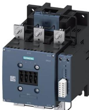
contattore di potenza AC-1 500 A / 690 V / 40°C a 3 poli, Uc: AC 96-127 V(50 ... 60 Hz) / DC ingresso PLC DC 24 V azionamento: elettronico contatti ausiliari 2 NO + 2 NC circuito princ.: sbarra circuito di comando e circuito ausiliario: attacco a vite con segnalazione di durata residua
