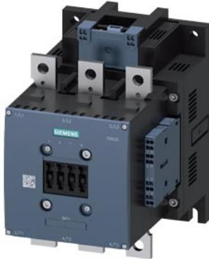
contattore ferroviario AC-1, 500 A comando in DC a 3 poli azionamento elettronico con PLC-IN DC 24-110 V Us 24 V x (0,7-1,25) contatti ausiliari 2 NO + 2 NC attacchi a sbarra blocchetto di contatti ausiliari e terminali della bobina in tecnica di collegamento a molla
