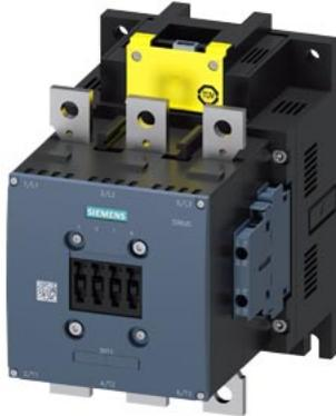
contattore di potenza AC-1 400 A / 690 V / 40°C a 3 poli, Uc: AC 96-127 V(50 ... 60 Hz) / DC ingresso PLC-F DC 24 V azionamento: elettronico contatti ausiliari 2 NO + 2 NC circuito princ.: sbarra circuito di comando e circuito ausiliario: attacco a vite
