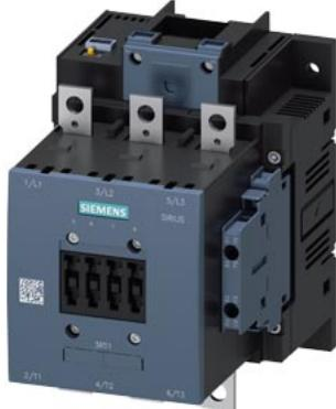
contattore ferroviario, AC-1 275 A, 690 V bobina DC 24V x (0,7-1,25) ingresso PLC DC 24-110 V contatti ausiliari 2 NO + 2 NC a 3 poli grandezza costruttiva S6 attacchi a sbarra morsetto di collegamento della bobina: morsetto a vite
