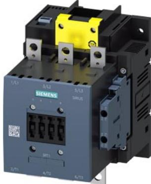
contattore, AC-1, 275 A/690 V/40 °C, S6, a 3 poli, AC/DC 200 ... 277 V, F-PLC-IN, con varistore, 2NO+2NC, sbarra di collegamento/ morsetti a vite
