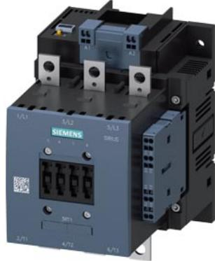
contattore ferroviario, AC-1 275 A, 690 V bobina DC 24V x (0,7-1,25) ingresso PLC DC 24-110 V contatti ausiliari 2 NO + 2 NC a 3 poli grandezza costruttiva S6 attacchi a sbarra morsetto di collegamento della bobina: morsetto a molla
