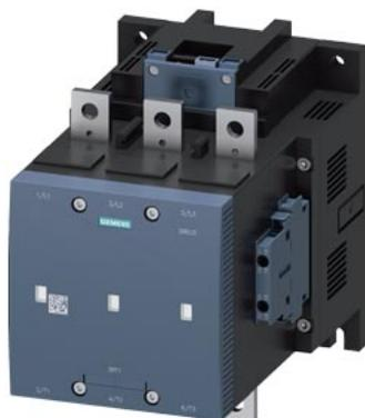
contattore sottovuoto, AC-3 500 A, 250 kW / 400 V AC (50...60 Hz) / comando in DC AC/DC 96-127V contatti ausiliari 2 NO + 2 NC a 3 poli, grandezza costruttiva S12 attacchi a sbarra azionamento: elettronico con interfaccia PLC DC 24 V
