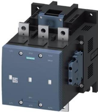
contattore sottovuoto, AC-3 500 A, 250 kW / 400 V AC (50...60 Hz) / comando in DC AC/DC 240-277V contatti ausiliari 2 NO + 2 NC a 3 poli, grandezza costruttiva S12 attacchi a sbarra azionamento: convenzionale
