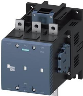
contattore sottovuoto, AC-3 500 A, 250 kW / 400 V AC (50...60 Hz) / comando in DC AC/DC 110-127V contatti ausiliari 2 NO + 2 NC a 3 poli, grandezza costruttiva S12 attacchi a sbarra azionamento: convenzionale
