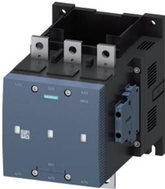
contattore sottovuoto, AC-3 400 A, 200 kW / 400 V senza bobina contatti ausiliari 2 NO + 2 NC a 3 poli, grandezza costruttiva S12 conduttore principale: attacchi a sbarra conduttore ausiliario: collegamenti a vite
