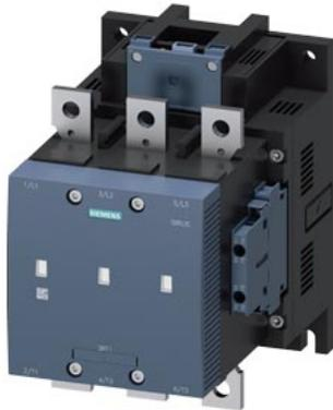
contattore sottovuoto, AC-3 300 A, 160 kW / 400 V AC (50...60 Hz) / comando in DC AC/DC 21-27,3V contatti ausiliari 2 NO + 2 NC a 3 poli, grandezza costruttiva S10 attacchi a sbarra azionamento: elettronico con interfaccia PLC DC 24 V
