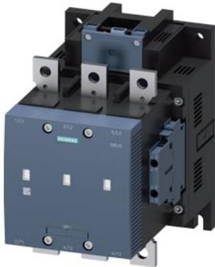
contattore sottovuoto, AC-3 265 A, 132 kW / 400 V AC (50...60 Hz) / comando in DC AC/DC 200-277V contatti ausiliari 2 NO + 2 NC a 3 poli, grandezza costruttiva S10 attacchi a sbarra azionamento: elettronico con interfaccia PLC DC 24 V
