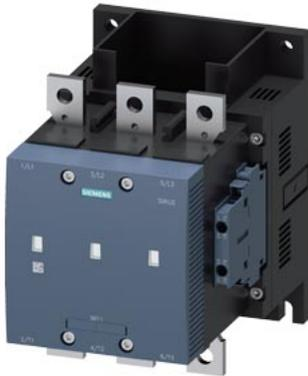
contattore sottovuoto, AC-3 senza bobina contatti ausiliari 2 NO + 2 NC a 3 poli, Grandezza costruttiva S10 conduttore principale: attacchi a sbarra conduttore ausiliario: morsetti a vite
