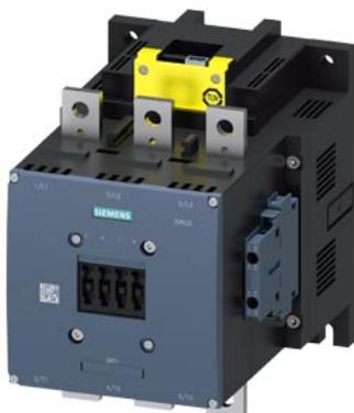
contattore di potenza, AC-3e/AC-3 500 A, 250 kW / 400 V AC (50 ... 60 Hz) / DC 96 ... 127 V x (0,8 ... 1,1) ingresso PLC F DC 24 V a 3 poli, contatti ausiliari 2 NO + 2 NC azionamento: elettronico circuito princ.: sbarra circuito di comando e circuito ausiliario: attacco a vite
