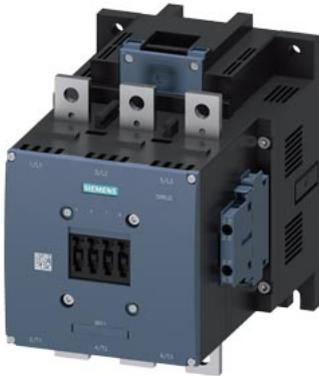
contattore di potenza, AC-3 500 A, 250 kW / 400 V AC (50...60 Hz) / DC AC/DC 110-127 V contatti ausiliari 2 NO + 2 NC a 3 poli, grandezza costruttiva S12
