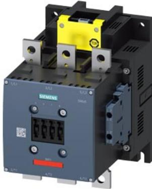
contattore di potenza, AC-3e/AC-3 300 A, 160 kW / 400 V AC (50 ... 60 Hz) / DC 200 ... 277 V x (0,8 ... 1,1) ingresso PLC F DC 24 V a 3 poli, contatti ausiliari 2 NO + 2 NC non rimovibili azionamento: elettronico circuito princ.: sbarra circuito di comando e circuito ausiliario: attacco a vite
