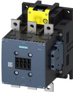
contattore di potenza, AC-3e/AC-3 300 A, 160 kW / 400 V AC (50 ... 60 Hz) / DC 96 ... 127 V x (0,8 ... 1,1) ingresso PLC F DC 24 V a 3 poli, contatti ausiliari 2 NO + 2 NC azionamento: elettronico circuito princ.: sbarra circuito di comando e circuito ausiliario: attacco a vite
