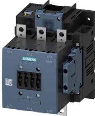
contattore di potenza, AC-3e/AC-3 185 A, 90 kW / 400 V AC (50 ... 60 Hz) / DC Uc: 21 ... 27, 3 V ingresso PLC DC 24 V a 3 poli, contatti ausiliari 2 NO + 2 NC azionamento: elettronico circuito princ.: sbarra circuito di comando e circuito ausiliario: attacco a vite
