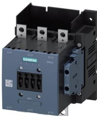
contattore di potenza, AC-3e/AC-3 185 A, 90 kW / 400 V senza azionamento a 3 poli, contatti ausiliari 2 NO + 2 NC senza azionamento circuito princ.: sbarra circuito di comando e circuito ausiliario: attacco a vite
