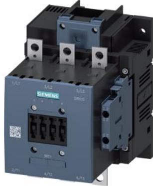
contattore di potenza, AC-3e/AC-3 185 A, 90 kW / 400 V AC (50 ... 60 Hz) / DC Uc: 575 ... 600 V a 3 poli, contatti ausiliari 2 NO + 2 NC azionamento: convenzionale circuito princ.: sbarra circuito di comando e circuito ausiliario: attacco a vite
