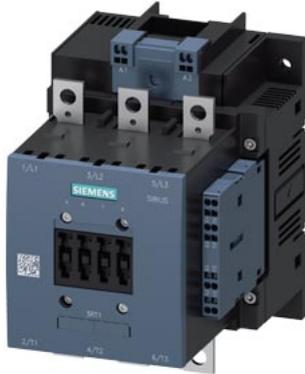
contattore di potenza, AC-3e/AC-3 185 A, 90 kW / 400 V AC (50 ... 60 Hz) / DC Uc: 110 ... 127 V a 3 poli, contatti ausiliari 2 NO + 2 NC azionamento: convenzionale circuito princ.: sbarra circuito di comando e circuito ausiliario: morsetti a molla
