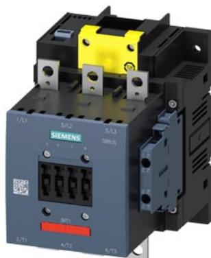
contattore di potenza, AC-3e/AC-3 150 A, 75 kW / 400 V AC (50 ... 60 Hz) / DC UC: 96 ... 127 V x (0,8 ... 1,1) ingresso PLC F DC 24 V a 3 poli, contatti ausiliari 2 NO + 2 NC non rimovibili azionamento: elettronico circuito princ.: sbarra circuito di comando e circuito ausiliario: attacco a vite
