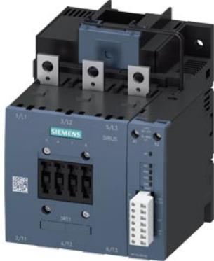
contattore di potenza, AC-3e/AC-3 150 A, 75 kW / 400 V AC (50 ... 60 Hz) / DC Uc: 200 ... 277 V ingresso PLC DC 24 V a 3 poli, contatti ausiliari 1 NO + 1 NC azionamento: elettronico circuito princ.: sbarra circuito di comando e circuito ausiliario: attacco a vite con segnalazione di durata residua
