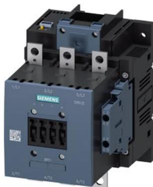
contattore di potenza, AC-3e/AC-3 150 A, 75 kW / 400 V AC (50 ... 60 Hz) / DC Uc: 21 ... 27, 3 V ingresso PLC DC 24 V a 3 poli, contatti ausiliari 2 NO + 2 NC
