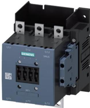
contattore di potenza, AC-3e/AC-3 150 A, 75 kW / 400 V senza azionamento a 3 poli, contatti ausiliari 2 NO + 2 NC senza azionamento circuito princ.: sbarra circuito di comando e circuito ausiliario: attacco a vite
