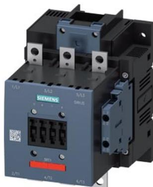
contattore di potenza, AC-3e/AC-3 150 A, 75 kW / 400 V AC (50 ... 60 Hz) / DC Uc: 110 ... 127 V a 3 poli, contatti ausiliari 2 NO + 2 NC non rimovibili azionamento: convenzionale circuito princ.: sbarra circuito di comando e circuito ausiliario: attacco a vite
