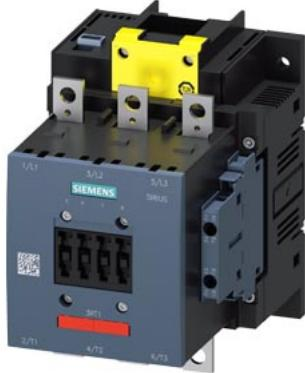
contattore di potenza, AC-3e/AC-3 115 A, 55 kW / 400 V, AC (50 ... 60 Hz) / DC Uc: 200 ... 277 V x (0,8 ... 1,1) ingresso PLC F DC 24 V a 3 poli, contatti ausiliari 2 NO + 2 NC non rimovibili azionamento: elettronico circuito princ.: sbarra circuito di comando e circuito ausiliario: attacco a vite
