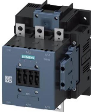
contattore di potenza, AC-3e/AC-3 115 A, 55 kW / 400 V, AC (50 ... 60 Hz) / DC Uc: 42 ... 48 V a 3 poli, contatti ausiliari 2 NO + 2 NC azionamento: convenzionale circuito princ.: sbarra circuito di comando e circuito ausiliario: attacco a vite
