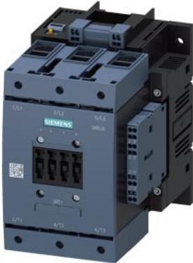
contattore di potenza, AC-3e/AC-3 115 A, 55 kW / 400 V, Uc: DC 72 V x (0,7 ... 1,25) ingresso PLC DC 24 ... 110 V a 3 poli, contatti ausiliari 2 NO + 2 NC azionamento: elettronico circuito princ.: morsetto serracavo circuito di comando e circuito ausiliario: morsetti a molla
