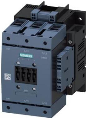
contattore di potenza, AC-3e/AC-3 115 A, 55 kW / 400 V, AC (50 ... 60 Hz) / DC Uc: 440 ... 480 V a 3 poli, blocchetto di contatti ausiliari a destra 3RH1921-2DE11 azionamento: convenzionale circuito princ.: morsetto serracavo circuito di comando e circuito ausiliario: morsetti a molla
