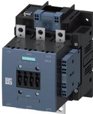
contattore di potenza, AC-3e/AC-3 115 A, 55 kW / 400 V, U<sub>c</sub>: DC 72 V x (0,7 ... 1,25) ingresso PLC DC 24 ... 110 V a 3 poli, contatti ausiliari 2 NO + 2 NC
