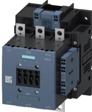
contattore di potenza, AC-3e/AC-3 115 A, 55 kW / 400 V, AC (50 ... 60 Hz) / DC Uc: 23 ... 26 V a 3 poli, contatti ausiliari 2 NO + 2 NC azionamento: convenzionale circuito princ.: sbarra circuito di comando e circuito ausiliario: morsetti a molla
