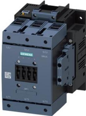
contattore di potenza, AC-3e/AC-3 115 A, 55 kW / 400 V, U<sub>c</sub>: DC 24 V x (0,7 ... 1,25) ingresso PLC DC 24 ... 110 V a 3 poli, contatti ausiliari 2 NO + 2 NC
