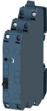
convertitore di segnale con interruttore manuale-automatico AC/DC 24 ... 240 V, Separazione a 3 vie ingresso: 0-10 V, 0/4-20 mA uscita: 0-10 V, 0/4-20 mA morsetto a vite
