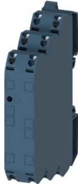
convertitore di segnale AC/DC 24 ... 240 V, Separazione a 3 vie ingresso: 0-60 mV, 0-100 mV 0-300 mV, 0-500 mV, 0-1 V 0-20 V, 2-10 V, 0-5 mA, 0-10 mA 2-10 V, 0-5 mA, 0-10 mA 0-20mA, 4-20mA, +-5mA, +-20mA uscita: 0 - 10 V, 0/4 ... 20 mA morsetto a molla (Push-in)
