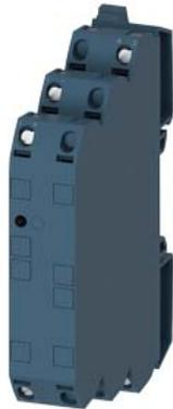
convertitore di segnale AC/DC 24 V. Separazione a 3 vie ingresso: 0-60 mV, 0-100 mV 0-300 mV, 0-500 mV, 0-1 V 0-2 V, 0-5 V, 0-10 mA, 0-20 V 2-10 V, 0-5 mA, 0-10 mA 0-20mA, 4-20mA, +5mA, +20mA uscita: 0 - 10 V, 0/4 ... 20 mA morsetto a vite
