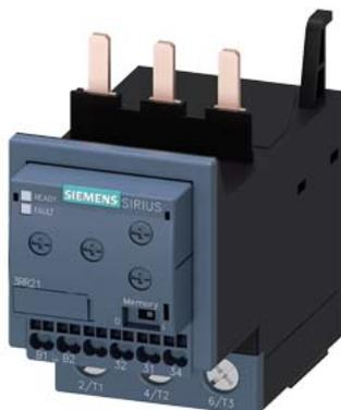
relè di controllo, applicabile al contattore 3RT2, grandezza costruttiva S2 Basic, a impostazione analogica sorveglianza di corrente apparente 8...80 A, 50...60 Hz, Bifase alimentazione AC/DC 24 V 1 contatto CO controllo di superamento in positivo e in negativo della corrente mancanza di fase, rottura conduttore con o senza memorizzazione errore ritardo all'avvio 0-60 s soppressione picchi di interferenze 0-30 s isteresi di commutazione 6% tecnica di collegamento a molla
