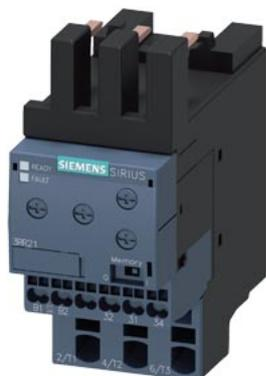
relè di controllo, applicabile al contattore 3RT2, grandezza costruttiva S0 Basic, a impostazione analogica sorveglianza di corrente apparente 4...40 A, 50...60 Hz, Bifase alimentazione AC/DC 24 ... 240 V 1 contatto CO controllo di superamento in positivo e in negativo della corrente mancanza di fase, rottura conduttore con o senza memorizzazione errore ritardo all'avvio 0-60 s soppressione picchi di interferenze 0-30 s isteresi di commutazione 6% tecnica di collegamento a molla
