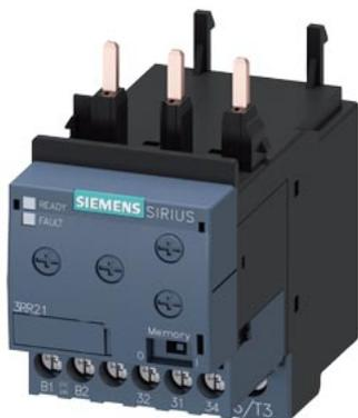
relè di controllo, applicabile al contattore 3RT2, grandezza costruttiva S0 Basic, a impostazione analogica sorveglianza di corrente apparente 4...40 A, 50...60 Hz, Bifase alimentazione AC/DC 24 ... 240 V 1 contatto CO controllo di superamento in positivo e in negativo della corrente mancanza di fase, rottura conduttore con o senza memorizzazione errore ritardo all'avvio 0-60 s soppressione picchi di interferenze 0-30 s isteresi di commutazione 6% tecnica di collegamento a vite
