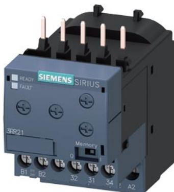
relè di controllo, applicabile al contattore 3RT2, grandezza costruttiva S00 Basic, a impostazione analogica sorveglianza di corrente apparente 1,6 ... 16 A, 20 ... 400 Hz, bifase alimentazione AC/DC 24 V 1 contatto CO controllo di superamento in positivo e in negativo della corrente mancanza di fase, rottura conduttore con o senza memorizzazione errore ritardo all'avvio 0-60 s soppressione picchi di interferenze 0-30 s isteresi di commutazione 6% tecnica di collegamento a vite
