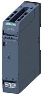
relè a tempo, elettronico con funzione stella-triangolo 1NO ritardato 1NO istantaneo 1 intervallo di tempo, 1...20 s AC/DC 12-240 V a AC 50/60 Hz con LED, morsetto a molla (Push-in)
