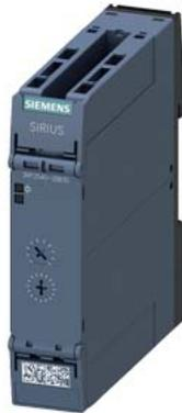
relè a tempo, elettronico ritardato alla diseccitazione senza segnale di comando o funz.sicuro passante all'inserzione a prova di mancanza tensione 7 campi di temporizzazione 0,05 ... 600 s AC/DC 24 V, 2 contatti CO con LED, morsetto a molla (Push-in)
