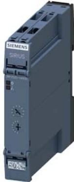
relè a tempo, elettronico ritardato all'eccitazione 1 contatto CO, 7 intervalli di tempo 0,05 s ... 100 h AC/DC 12-240 V a AC 50/60 Hz con LED, morsetto a vite
