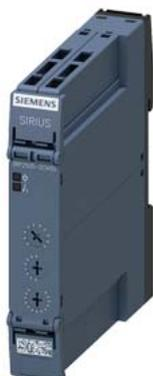
relè a tempo, multifunzione semiconduttore 1 NO 13 funzioni 7 campi di temporizzazione (0,05 s...100 h) AC/DC 12-240 V a AC 50/60 Hz con LED, morsetto a molla (Push-in)
