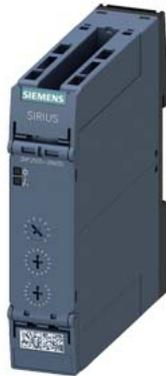
relè a tempo, multifunzione 2 contatti CO, 27 funzioni 7 intervalli di tempo (0,05 s...100 h) AC/DC 12-240 V a AC 50/60 Hz con LED morsetto a molla (Push-in)
